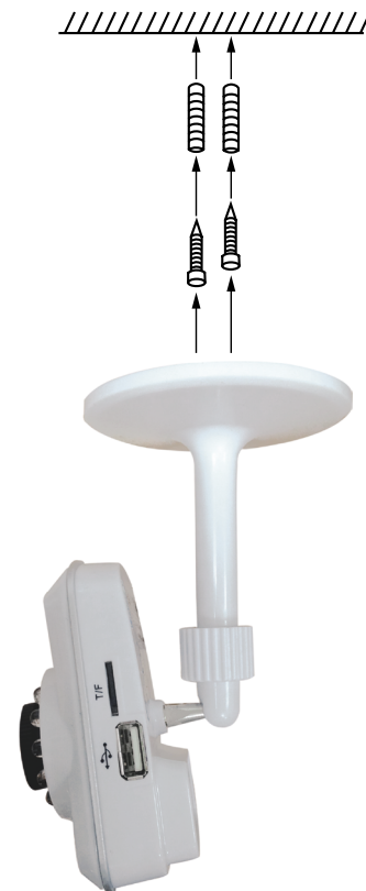
Рис.2.5 Камера установлена на кронштейне.
